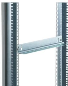
Las guías de equipo ayudan a soportar el equipo montado en rack durante la instalación. Las guías se montan entre dos pares de ángulos de rack. Se proporcionan orificios ranurados para ajuste vertical o lateral. Se suministra en pares. Se incluyen los herrajes de montaje
