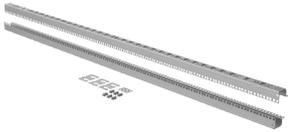
Los ángulos del rack ProLine G2 se montan con sujetadores BV-M6 en lugar de la combinación tradicional de tuerca enjaulada y tornillo. La altura del ángulo del rack y el recuento de unidades del rack están optimizados para las alturas del marco ProLine G2. Los ángulos del rack tienen dos superficies de montaje que sirven para la conexión de equipos y accesorios de montaje en rack. Los ángulos del rack cumplen con las normas de montaje en rack AN SI/EIARS-310-D.
