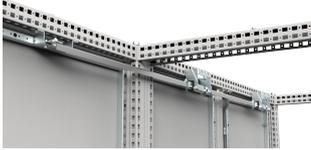
Esta barra de conexión acopla mecánicamente un actuador del sistema con el kit de interbloqueo de la puerta secundaria y permite abrir la puerta secundaria únicamente tras haber abierto la puerta principal.
