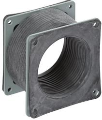
Los conectores flexibles se usan para aislar un recorrido del ducto del impacto y las vibraciones o compensar los desajustes de alineación. Se utiliza cuando se requieren ángulos inusuales (que no excedan 90 grados). Permite el movimiento de una máquina o estación de control conectada a un ducto para cables. Fuelle de hipalón con bridas de acero. Se conecta a otras secciones del ducto y protege alambres y cables contra el polvo, en una amplia gama de aplicaciones industriales.
