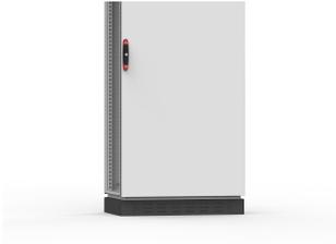
El zócalo delantero y trasero permite disponer el cableado sin restricciones de acuerdo con la norma VDE 0113. La instalación de los cables se realiza fácilmente ya que el zócalo habilita un espacio adicional debajo del armario. Las rejillas de ventilación permiten una ventilación natural en esta zona debajo del armario.
