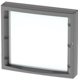
El kit de ventana con bisagras profundas Concept se puede utilizar como kit de ventana accesorio en puertas de gabinete estándar nVent HOFFMAN más grandes. Proporciona un espacio de dos pulgadas entre la abertura frontal del gabinete y la superficie de la ventana, con capacidad para interruptores, luces, medidores y otros componentes.
