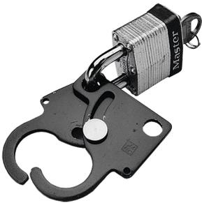
Los bloqueos de seguridad de acceso doble proporcionan un medio para utilizar dos candados en una fuente de alimentación segura. Se puede retirar cualquiera de los candados para interrumpir la alimentación y acceder al gabinete. Los orificios de candado tienen un diámetro de 0.38 pulg. (10 mm)
