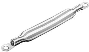
Las cintas de conexión a tierra pueden utilizarse para proporcionar continuidad eléctrica entre piezas metálicas que deben conectarse eléctricamente. Cada cinta consta de una longitud de cobre trenzado con una terminal de anillo en ambos extremos. La trenza está aislada con plástico a rayas verdes y amarillas.
