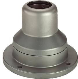
CS480 La base giratoria para fijación externa permite que todo el sistema de suspensión gire en el punto del acoplamiento sobre una superficie horizontal. El brazo se puede rotar o girar 340°. Los herrajes de montaje de la base están expuestos. Rodamientos libres de mantenimiento.
