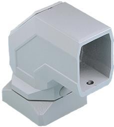
El acoplamiento de codo de brida Compact Series 2 se conecta directamente al gabinete para aplicaciones donde no se requiere un tubo vertical, lo que permite la rotación del gabinete a 300 grados. El rodamiento no requiere mantenimiento y es de acero y poliamida. Incluye una placa de acceso para una fácil instalación de cables.
