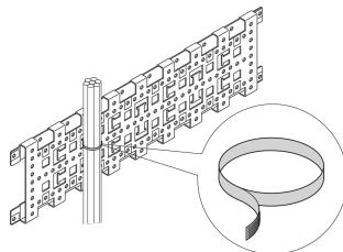
La tira de velcro® es una de las soluciones de agrupación de cables más sencillas. La tira de velcro® nVent permite cables de hasta 43 mm de diámetro.
