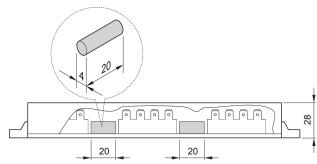
Bloques aislantes para barras colectoras para proteger los terminales de cortocircuitos accidentales y daños. Los bloques proporcionan un soporte rígido para separar físicamente las barras de bastidor de todas las fuentes de energía eléctrica y están diseñados para un fácil montaje de la barra de bastidor.
