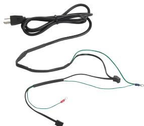
Se utiliza para alimentar ventiladores axiales compactos de 120 VAC; sustituye al cable de alimentación suministrado. El cable del ventilador incluye termostato en línea. Los ventiladores se encenderán cuando el termostato en línea alcance 86 °F (30 °C). Los ventiladores sólo funcionarán cuando la temperatura sea superior a 86 °F (30 °C). Para usarse con ventiladores de 110-120 VAC sólo con cables de alimentación. Pueden usarse uno o dos ventiladores con el cable de alimentación.
