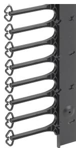
Los soportes reductores ProLine CableTek separan, sujetan y manejan el cable dentro de los gabinetes ProLine. El soporte se monta en el lado izquierdo o derecho de los gabinetes de 700 y 800 mm entre el marco y el ángulo del rack para crear espacio de cableado vertical. Los dedos están hechos de plástico negro moldeado. Tenga en cuenta que se incluye el herraje de montaje.
