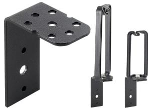
El soporte de anillo en D universal monta los anillos en D (se piden por separado) en el gestor de cables de atado vertical ProLine o de red, el soporte de anillo en D ProLine de adelante hacia atrás o al riel sujetador. El anillo en D se bloquea en el orificio provisto en el soporte, al crear soporte para la gestión de cableado. Está hecho de acero, recubierto con pintura en polvo de poliéster negro RAL 9005 e incluye hardware de montaje.
