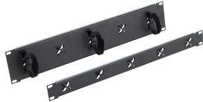
Los paneles de amarre de marco abierto proporcionan un punto de montaje para tender el cable en un rack de marco abierto. Se montan horizontalmente en racks de 19 pulg. y los paneles tienen ranuras para envoltura de VELCRO® para cables. Cada panel incluye 10 envolturas de VELCRO para cables color negro de 8 pulg. (203 mm) con los herrajes de montaje. Tenga en cuenta que VELCRO es una marca comercial de Velcro Industries BV
