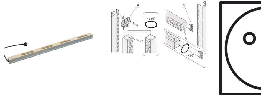
PDU modular y compacta con muchos elementos funcionales. Utilizando un chasis de aluminio de 1 U por 1 U, la PDU se puede integrar fácilmente en un rack con salidas UTE.
