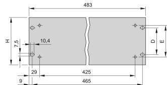
Defina los frentes del dispositivo y los laterales inss con los paneles delanteros Schroff 19". Los paneles delanteros Schroff de 19" tienen agujeros adicionales para el montaje de manijas y están disponibles en demensiones de 1 U a 6 U.
