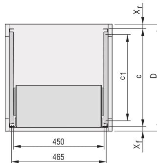
Guías telescópicas con perfil de guía para montaje en armarios con capacidad de carga de 25 kg.
