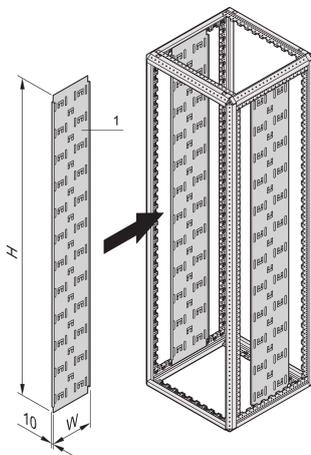
Panel de cable vertical para armarios de pie libre Varistar pulverizados en color gabinete en diferentes anchos.
