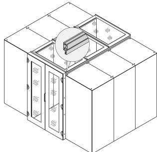
Perfil que permite la fácil fijación de cubiertas superiores de pasillo. Aumenta la altura del pasillo y el punto de fijación para accesorios. Cubre hasta 4 racks.
