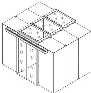
Paneles de corte para diferentes alturas de contención de pasillo para evitar fugas de aire en el pasillo.
