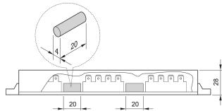
Bloques aislantes para barras colectoras para proteger los terminales de cortocircuitos accidentales y daños. Los bloques proporcionan un soporte rígido para separar físicamente las barras de bastidor de todas las fuentes de energía eléctrica y están diseñados para un fácil montaje de la barra de bastidor.
