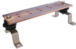
Un enlace correcto es esencial para generar un plano equipotencial entre las conexiones a tierra del servicio y las del equipo durante condiciones transitorias y de falla. Este plano equipotencial proporciona un diferencial de tensión cero y protege a las personas y los equipos durante estas situaciones. El producto de enlace más usado en la actualidad es la barra de conexión a tierra.
