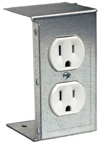
La salida dúplex de 15 amperios está montada en fábrica en un gabinete de acero chapado de tres lados. El gabinete de salida se monta en el lado de la bisagra de la puerta en la esquina inferior del gabinete. Se suministra el herraje de montaje.
