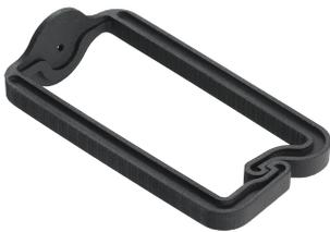
La gestión de cableado anillo en D puede usarse para manejar los cables horizontalmente, verticalmente o en la transición. La función de encaje a presión permite un acceso fácil a los cables, además de formar una conexión firmemente cerrada. El paquete incluye 10 anillos y 10 tornillos de montaje.
