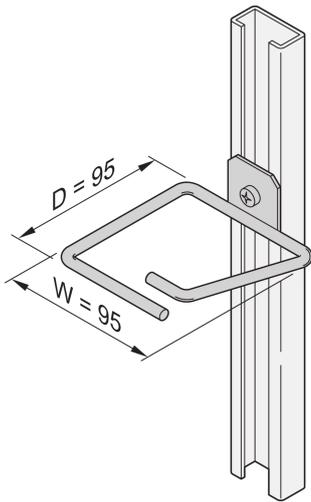
Los ojos del cable se pueden unir a los carriles deslizantes, paneles de cable, etc.
