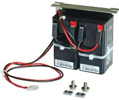
Paquete de baterías: Preparado para la integración en caja de puerta; 1200 ciclos de carga, soporte de apertura para 8 puertas, tensión de carga de 14,7 VDC a través de placa de puerta, temperatura ambiente -15 °C ... +50 °C.
