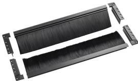
Utilice los kits de cepillos para piso para sellar recortes de tamaños poco comunes. El diseño de corte a la medida es fácil de instalar con tiras adhesivas aplicadas de fábrica. Los clips de riel lateral de diseño especial proporcionan protección de cables según NFPA 75, sección S-4.4. NEC, UL y NEMA requieren cubiertas de seguridad y protección de cables contra bordes afilados.
