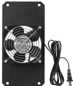
Los kits de ventiladores AccessPlus son una solución de cuatro pulgadas y 115 VAC que proporciona flujo de aire a través de los gabinetes a 100 CFM. Se incluyen la placa de montaje y los herrajes. La placa de montaje pequeña es de 5.32 (135 mm) x 8.00 (203 mm) y se adapta a gabinetes donde C = 18.00. La placa de montaje grande es de 5.32 (135 mm) x 10.75 (273 mm) y se adapta a gabinetes donde C = 25.00 o 30.00.
