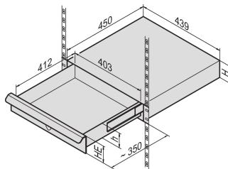
Cajones de 19" permiten el montaje de ordenadores portátiles, superficies de escritura para operaciones fáciles. El cajón SCHROFF 19" tiene una capacidad de carga de 15 KG, lo que permite montar una amplia gama de productos en el cajón.
