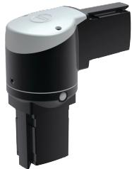
El codo giratorio Sysspend 281-Max proporciona una curva de 90° en el sistema de suspensión y permite que el tubo vertical gire 300°. Incluye tope de seguridad y rodamiento libre de mantenimiento.
