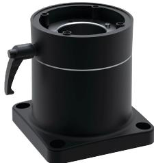
El acoplamiento base Sysspend 281-Max fija el gabinete directamente a una superficie horizontal. El gabinete se puede girar 300° y fijarse en la posición deseada. Incluye tope de seguridad y rodamiento libre de mantenimiento.
