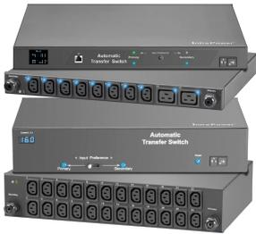
Los interruptores de transferencia automática de racks proporcionan redundancia de energía a los dispositivos de TI montados en rack que no están diseñados para aprovechar la segunda fuente de energía de los centros de datos. Los dispositivos ATS proporcionan conmutación por falla de energía para dispositivos de un solo cable.
