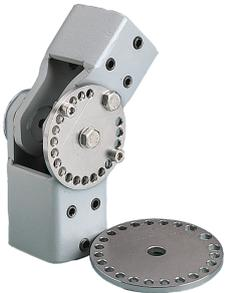
El limitador de rotación Compact Series 4 es un accesorio para usar con junta de pared, junta de pared de cable y unión intermedia. Limita la rotación de estas articulaciones que normalmente giran 180° y proporciona paradas en incrementos de 15°.
