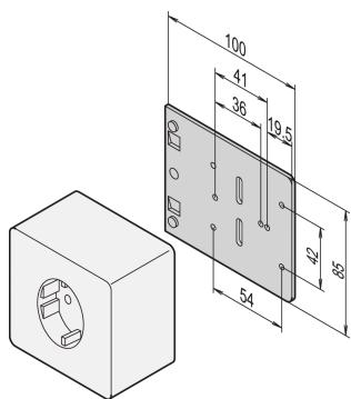
Placa de montaje para solo Socket.
