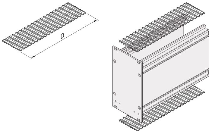
Placa de cubierta para unidades enchufables tipo bastidor, con perforación garantiza un caudal de aire de aproximadamente 65%. La placa se inserta en una ranura del panel lateral.
