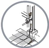
Malla prefabricada para la puesta a tierra del eje del conmutador y de la palanca de mando
