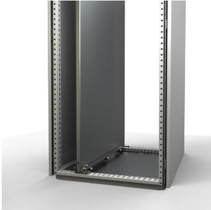
La placa de montaje completamente equipada puede insertarse fácilmente en el armario por el lateral, algo esencial ya que su anchura es superior a la de la abertura frontal. A continuación, se fija en su posición gracias a los perfiles en U.
