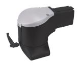
El acoplamiento de codo de brida Syspend 180-Max se conecta directamente al gabinete para aplicaciones donde no se requiere un tubo vertical. Permite que el gabinete gire 300° y se puede bloquear en una posición determinada. El acoplamiento de codo de brida tiene un tope de seguridad y rodamientos libres de mantenimiento.
