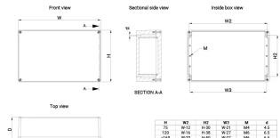
La gama de cajas para bornas de poliéster MGRP, con grado de protección IP 66-67, está disponible lista para uso en muchos tamaños diferentes. La gama MGRP es idónea para entornos de interior y exterior, gracias a una alta resistencia a la corrosión y a la radiación ultravioleta. Al impedirse la entrada de agua y polvo en la caja para bornas, se elimina el riesgo de fallo de componentes y, con ello, de tiempo de inactividad.
