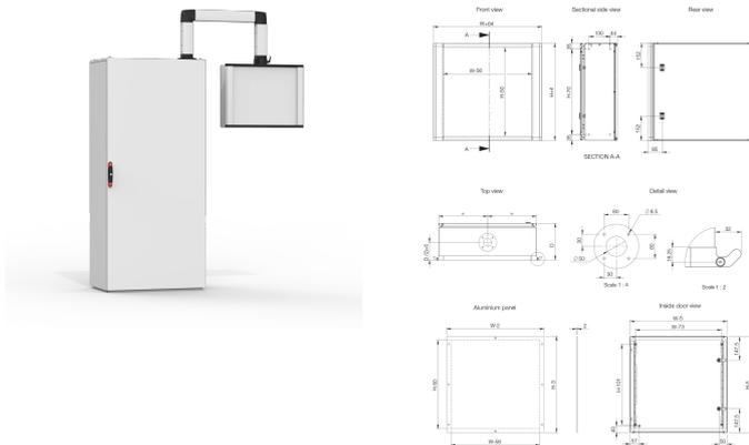
El armario de control de interfaz para el operador en acero dulce, OICE, tiene un patrón de taladros premecanizado para permitir la fijación a un brazo articulado, además de una placa frontal extraíble con un grado de protección IP 55. Los componentes pueden instalarse fácilmente gracias a la placa frontal extraíble, pero también serán fácilmente accesibles a través de una puerta trasera. Las asas laterales del armario facilitan el movimiento del armario a la posición de trabajo.
