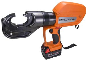
TaskMaster de nVent ILSCO: una herramienta de empalme con agarre de pistola de 12 toneladas (130 kN) que se puede utilizar con la gama de conectores de compresión de puesta a tierra de nVent ERICO. Los empalmes tipo C y E son compatibles con esta herramienta, además de con los troqueles de nVent ILSCO.
