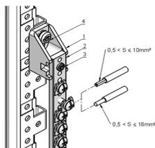
Tira metálica típicamente alojada dentro del equipo de distribución, tableros de paneles y cajas de vías de transporte para la distribución local de energía de alta corriente. También se utilizan para conectar equipos de alto voltaje en las centralitas eléctricas, y equipos de bajo voltaje en bancos de baterías.
