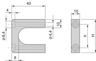
Las manijas delanteras se pueden montar y proporcionar un montaje más fácil de montar. Las manijas se pueden ensamblar desde el lado frontal.
