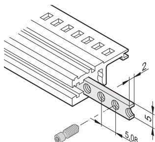
El inserto roscado es una tira metálica con rosca M2.5 y permite la fijación de paneles frontales.
