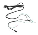
Se utiliza para alimentar ventiladores axiales compactos de 120 VAC; sustituye al cable de alimentación suministrado. El cable del ventilador incluye termostato en línea. Los ventiladores se encenderán cuando el termostato en línea alcance 86 °F (30 °C) Los ventiladores sólo funcionarán cuando la temperatura sea superior a 86 °F (30 °C) Para usarse con ventiladores de 110-120 VAC sólo con cables de alimentación. Pueden usarse uno o dos ventiladores con el cable de alimentación.
