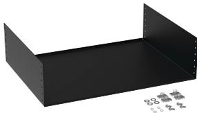
El estante para gabinete de PC de red es un estante de acero para su uso en el compartimento inferior del gabinete de PC de red. El compartimento del gabinete tiene capacidad para hasta dos estantes. El estante se monta en los puntales de montaje accesorios y se puede ajustar en intervalos de 1 pulg. (25 mm) dentro del gabinete. Tenga en cuenta que el rack se instala sin ángulos de rack y no es compatible con el ángulo de rack ERA1910TPL.
