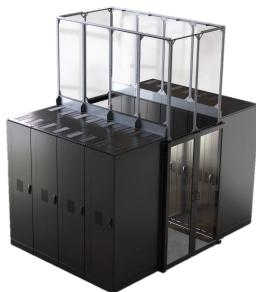
Funciona con un grupo de gabinetes que rodean un pasillo caliente. Está soportado en la parte superior de los gabinetes y canaliza el aire caliente que escapa del equipo de servidores alojados dentro de los gabinetes hacia el plénium en el techo. Esto se usa para separar completamente el aire frío del aire caliente, lo que reduce drásticamente los costos de energía del centro de datos.
