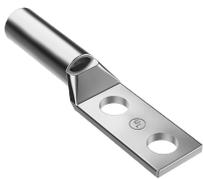
Las zapatas de compresión dan terminación a los conductores de cobre o cobre estañado para la conexión a barras colectoras, gabinetes, racks y guía de cables. Están codificados por color según el tamaño del conductor. La instalación de las zapatas de compresión requiere dos tornillos (no incluidos).
